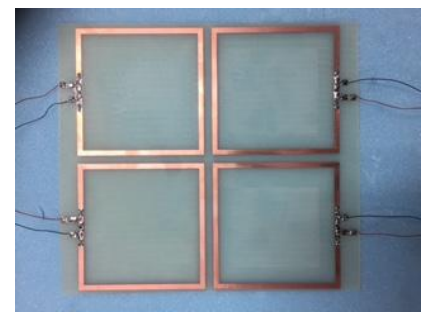
図5: 無給電素子アレーの試作品.
