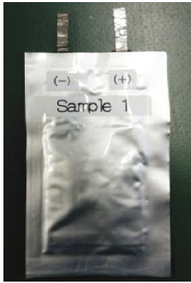
Figure 1 実験に用いたラミネート型二次電池.
