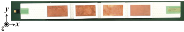
図 7: 2次元シート給電4素子パッチアンテナアレーの試作モデル.
