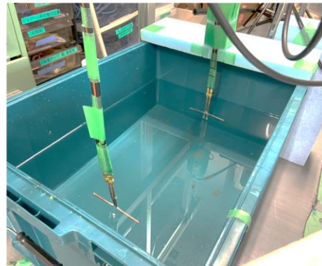
図3 伝搬実験の実験系
