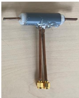
図1 ハーフシース型ダイポールアンテナの構造 ( 2a=3 mm, 2b=13 mm, 2c=18 mm, 2L=100 mm, A=60 mm)
