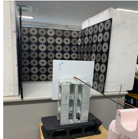
図3 読み取りエリア外の電界分布の測定
