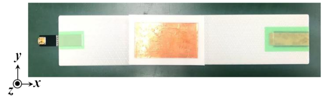
図3: 2次元シート給電単素子パッチアンテナの試作モデル。
