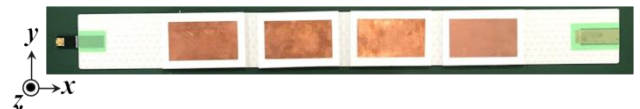
図7：2次元シート給電4素子パッチアンテナアレーの試作モデル。
