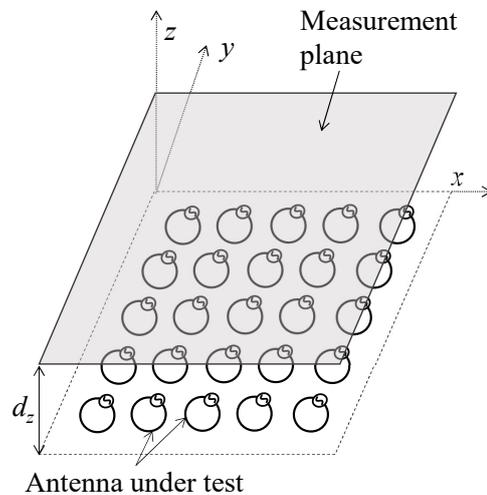
Fig. 1. Loop array antenna.
