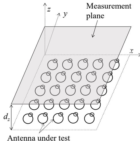
Fig. 1. Loop array antenna.
