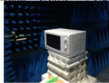
図 2 電子レンジからの放射波の測定。
